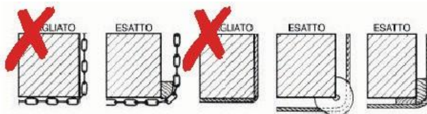
Protezioni per catene e funi in corrispondenza di spigoli del carico
